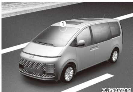
[1]: камера фронтального обзора
