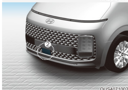
[1]: Камера фронтального обзора, [2]: Фронтальный радар
