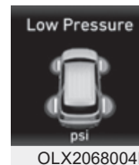
Указатель положения низкого давления в шине и индикатор давления в шинах
