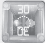
В перегоревшем состоянии
