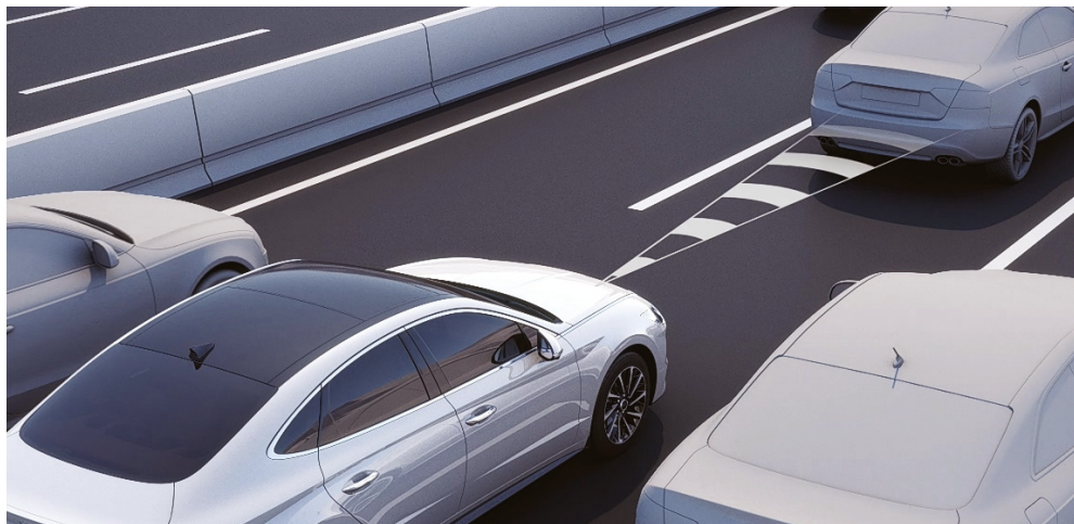
Система автоматического торможения перед препятствием спереди (FCA) Система предотвращения фронтального столкновения при повороте налево на перекрестке (FCA-JT)
